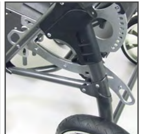
Транспортировочное крепление ( по норме ISO 7176-19)
