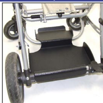
Шасси укрепленное с платформой для приборов жизнеобеспечения
